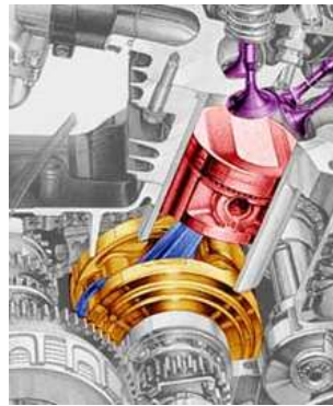
FIG. 1 – Vue descriptive d'un moteur 4 temps
